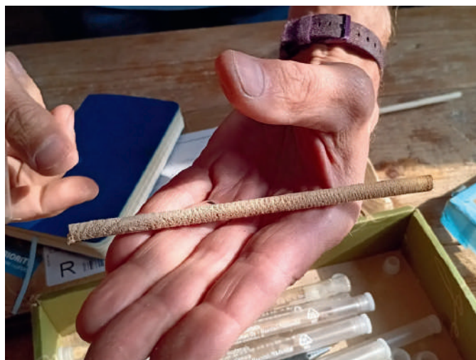
Under sommaren tog Stefan Blomqvist borrhövar ur stockväggarna i bagarstugan för att ta reda på byggnadens ålder.
