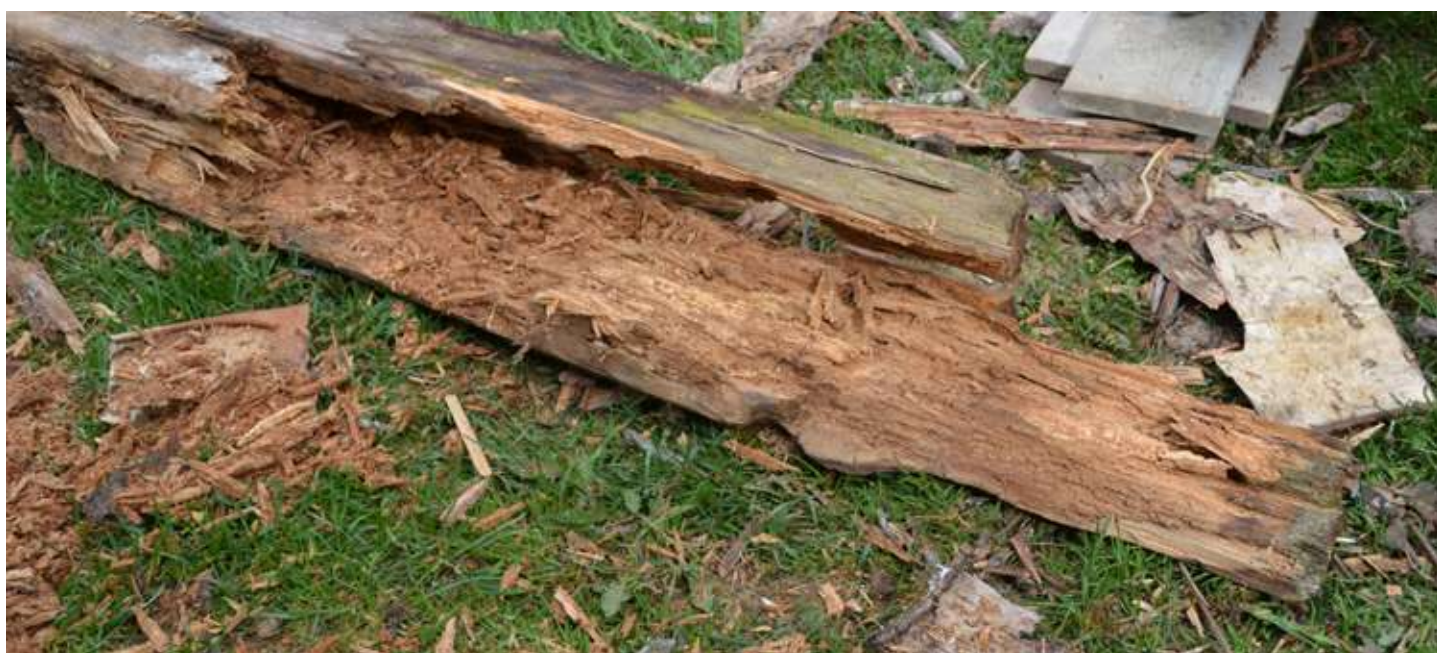
Skador på virket orsakas ofta av många olika faktorer sammantagna: Fukt, rötsvampar och insekter. Puun vaurioitumisen aiheuttaa usein monta tekijää yhdessä: Kosteus, lahottajasisenet ja hyönteiset.
